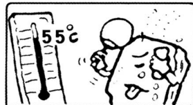
عدم نصب در محلهای بالای +۵۵ درجه و پایین -۲۵ درجه سانتیگراد (Extreme heat and cold, acceptable temperature rang: -25°C - +55°C)
