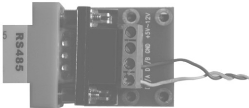
(شکل شماره ۲ نمونه پورت RS232/RS485 با تغذیه 5VDC)
