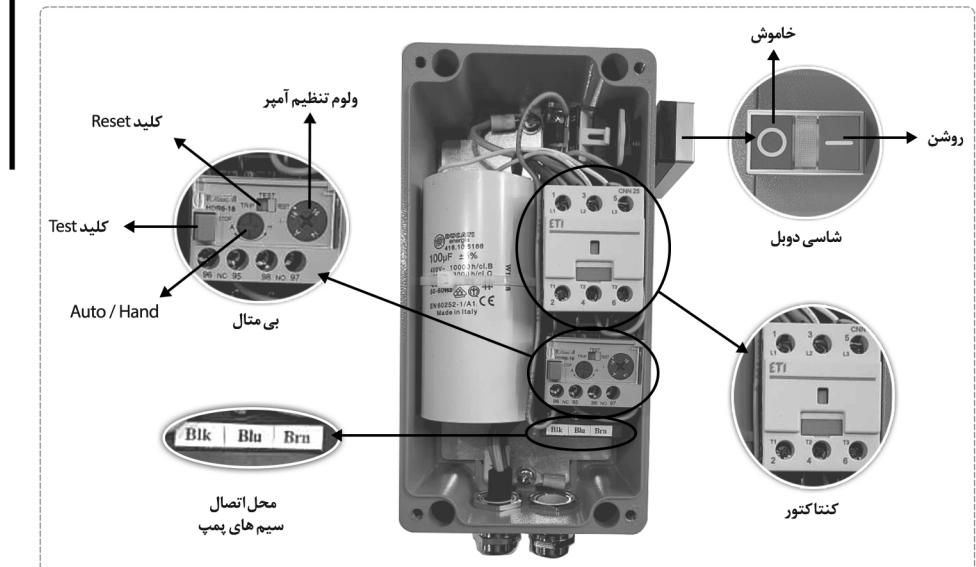
۲- کلیل برق ورودی موجود در جعبه کنترل IP65 را از طریق حداقل یک کلید مینیاتوری با آمپر مناسب مطابق با آمپر مصرفی پمپ به برق شبکه وصل نمایید.
