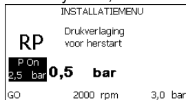
Afb. 17: Instelling van de herstartdruk
