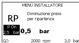
Figura 17: Impostazione della pressione di ripartenza
