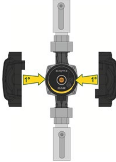
Resim 7: Pompa gövdesinin yalıtımı
