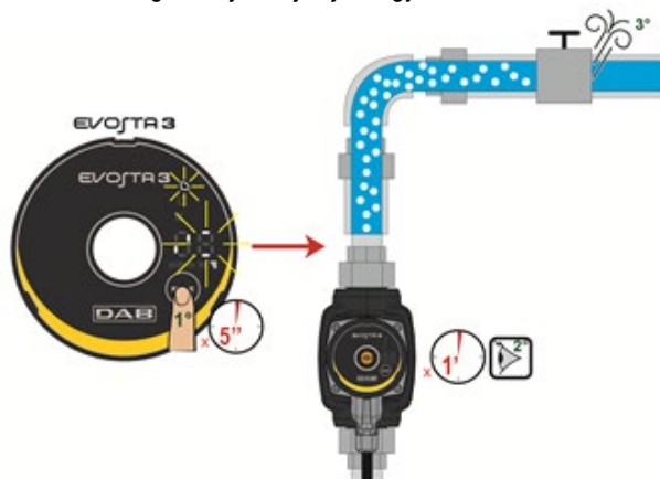
9. ábra: A pumpa automatikus légmentesítése
