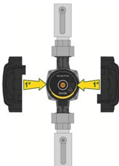
Малюнок 7: Ізоляція корпусу насоса
