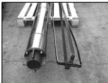
شماره دو : غلاف و پمپ شناور
