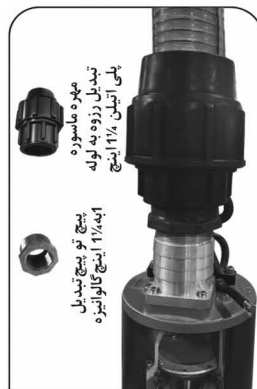
استفاده از مهره ماسوره تبدیل پلی اتیلن برای استفاده از لوله های PVC
